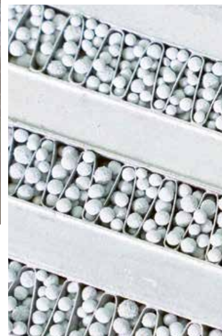
Zeolith-Granulat kann als Langzeit-Wärmespeicher dienen.
