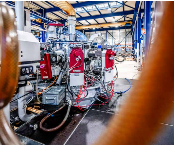
Alle Rundtaktmaschinen haben einen sternförmigen Aufbau.
