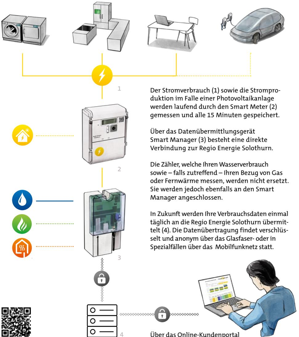
Der Stromverbrauch (1) sowie die Stromproduktion im Falle einer Photovoltaikanlage werden laufend durch den Smart Meter (2) gemessen und alle 15 Minuten gespeichert.
